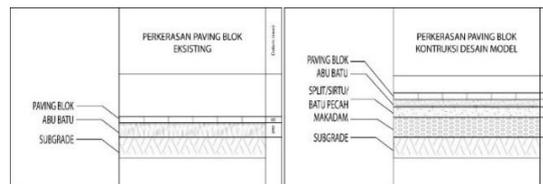
Gambar 22 Perbandingan Konstruksi Desain Model Perkerasan Paving Blok Eksisting dengan Konstruksi Desain Model Perkerasan Paving Blok sesuai SE Nomor 04/SE/Db/2017
