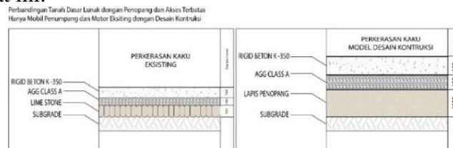
Gambar 14 Perbandingan Konstruksi Desain Model Perkerasan Kaku Eksisting dengan Konstruksi Desain Model Perkerasan Kaku sesuai SE Nomor 04/SE/Db/2017 pada Tanah Dasar Lunak dengan Penopang dan Akses Terbatas Hanya Mobil Penumpang dan Motor
